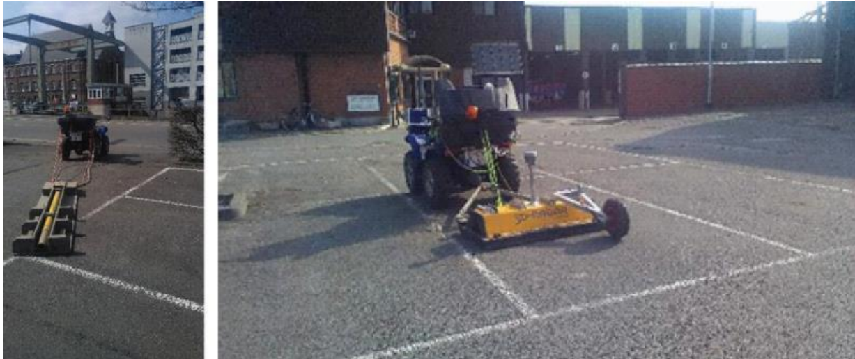
Figuur 40 Mobile sensorconfiguratie met de EMI sensor in de slede en RTK-GPS (links), de mobiele GPR meetconfiguratie in werking op de site (rechts).
